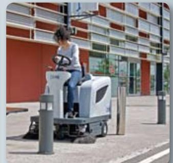
A SR 1101 está desenhada para se adaptar a todo o tipo de necessidades de limpeza, oferecendo uma grande manobrabilidade em áreas congestionadas e subindo rampas de até 20% de inclinação.
