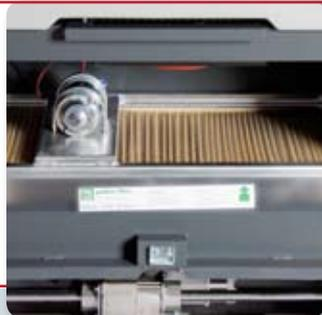
O sistema eléctrico de sacudidor do filtro limpa automaticamente a cada 5 minutos o filtro.
